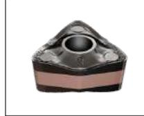
Стружколом для тяжелой обработки нержавеющей стали. Пластины со спиральной режущей кромкой и положительным передним углом.
