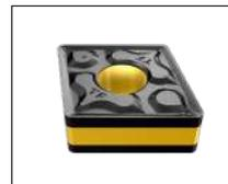
Двухсторонняя, положительный передний угол предотвращает деформационное упрочнение. Передний угол меняется вдоль кромки до негативного для устранения скалывания. Для углеродистой, легированной, нержавеющей стали и жаропрочных сплавов.
